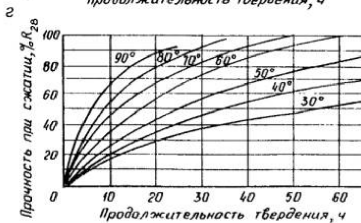
Рис. 5. Кривые набора прочности бетоном при различных температурах его выдерживания:
